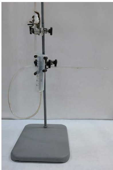
Рис. 2.2. Прилад для визначенні об'єму кореневої системи за об'ємом витісненої рідини.
