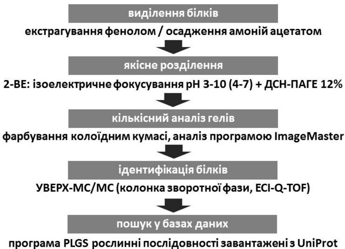
Рис. 2.2. Експериментальний протокол виділення, розділення та ідентифікації білків.
