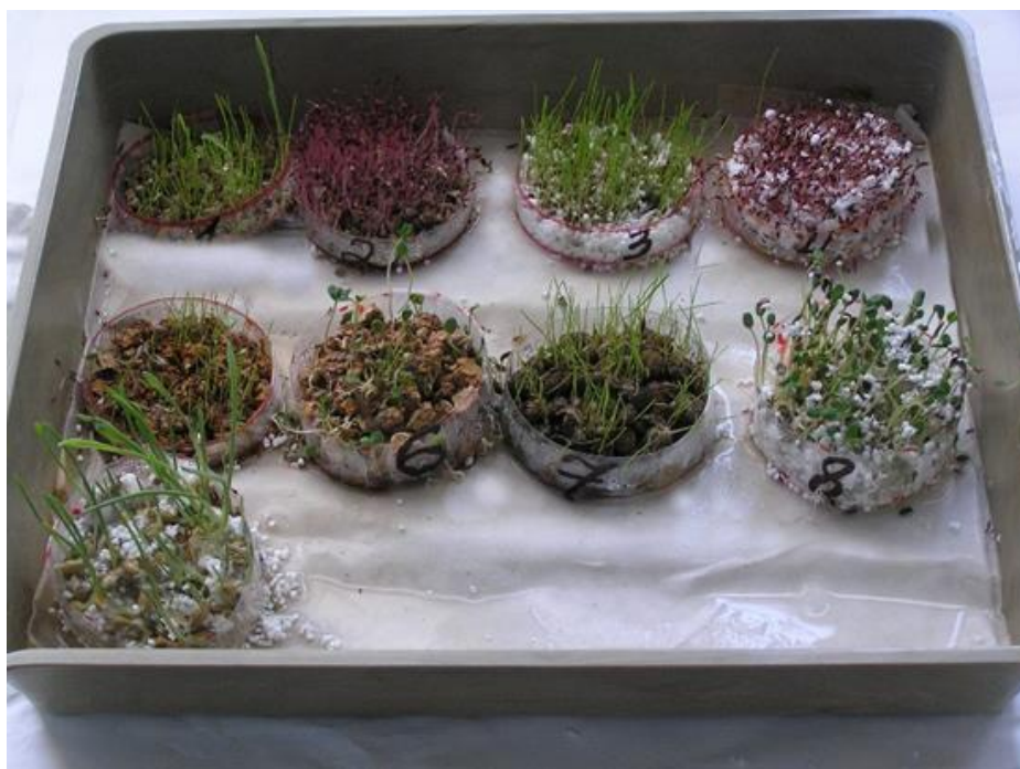
Рис. 5.1. Вигляд біоплато з використанням різних типів плаваючого субстрату на 10-у добу спостереження
