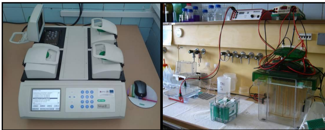
Рисунок 2.4 Використане під час дослідження обладнання для ампліфікації ДНК, електрофорезу ДНК у агарозному гелі та білків у ПААГ
