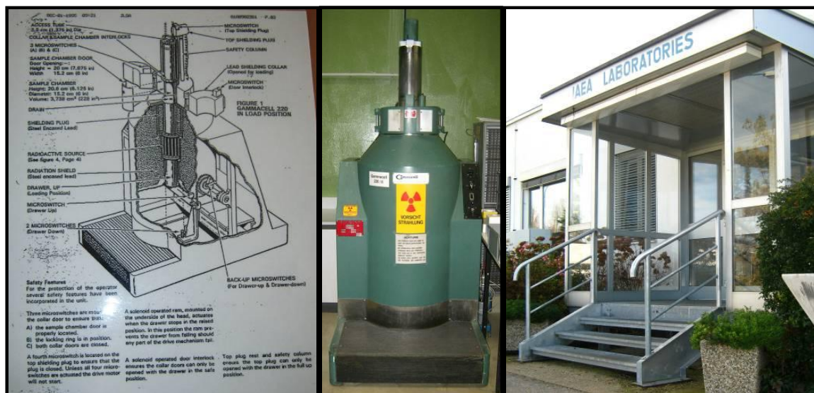
Рисунок 2.2 Гамма-установка Gammacell GC.-220 type B, що була використана для опромінення проростків ІВ. Міжнародна агенція з атомної енергії, Вена, Австрія.
