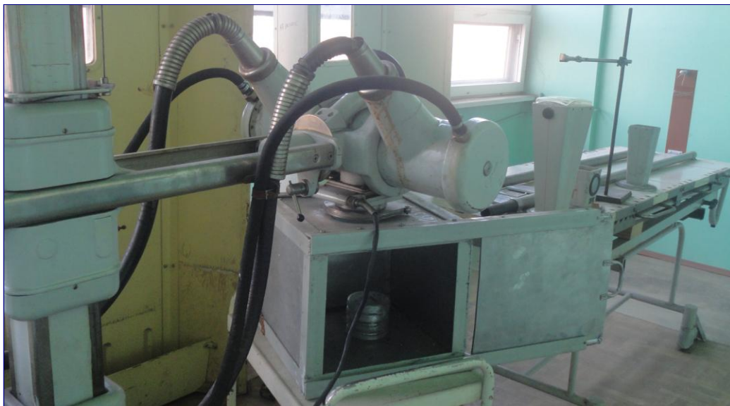
Рис. 2.4. Рентгенівський апарат РУМ-17, змонтований в дослідницькій лабораторії Національного інституту раку (м. Київ, Україна)
